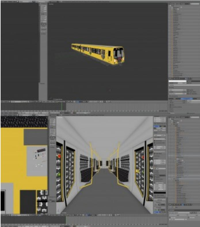
Bild 1: Ursprung für Rad und Drehgestell(gruppe) und korrekte Parentzuweisung, jedoch mit vielen Einzelmeshs (kann man zusammenfassen)
