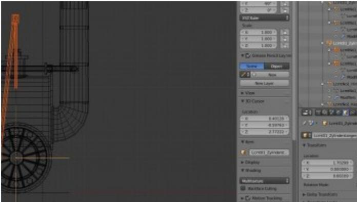
Jetzt wird die ganze Gruppe um ihren Ursprung so gedreht, daß die Kolbenstange parallel zur x-Achse liegt. Merkt euch den genauen Winkel! Danach ist es Zeit, ein weiteres Mal mit "Apply Rotation" drüberzufahren.
