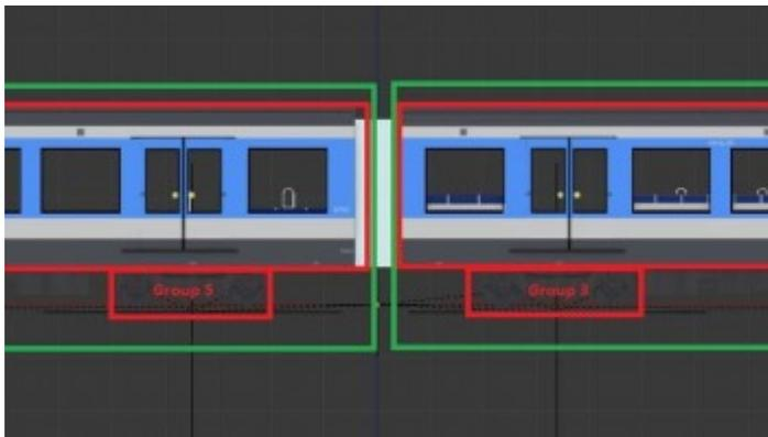
Meist erstellt man zudem mehrere Exemplare der selben Group, welche verschieden detailreiche Meshs enthalten. Sobald man mit der Kamera weiter weg geht, wird die zweite Group (das zweite Lod = Level of detail) eingeblendet, in der dann sehr detailreiche Meshs wie z.B. Haltestangen und Inneneinrichtung nicht mehr vorkommen. Dafür dürfen die einzelnen Objekte im CAD Programm nicht verschmolzen werden, sondern müssen nach dem Export als eigenes Mesh vorhanden sein (eigene .msh/.msh.blob Datei).
