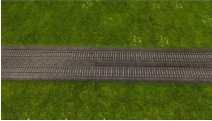
Links ein "echtes", rechts ein "falsches" Doppelgleis. Falsche Doppelgleise können durch Weichen etc. entstehen.
