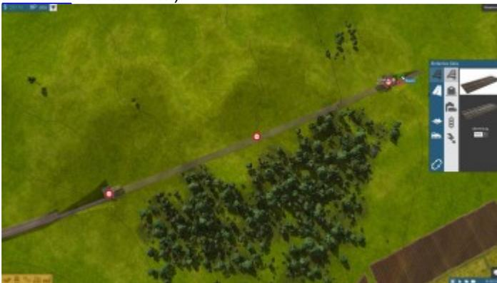
Für einfache, nicht all zu lange Tunnel ist diese Bauweise auch völlig ausreichend. Es ist allerdings zu beachten, dass der Gesamte Tunnel dadurch zu einem unzerstörbaren Element wird. möchte man also ein Gleis des Tunnels oder nur ein Tunnelportal abreißen, ist dies nicht möglich. Es wird immer der gesamte Tunnel abgerissen.
