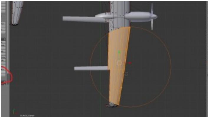
Die ausgeschnittenen, durch die Schablone begrenzten neuen Teile sind praktischerweise gleich markiert und man kann mit ihnen verfahren, wie man mag. Mit "P" kann man sie zum Beispiel zu einem eigenen Objekt ernennen und wegschieben (was bei einer Tür praktisch sein wird) oder gleich löschen.
